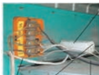
کابل رابط سه سیمه ی خازن اصلاح ضریب سیم رابط پمپ موتور دو دور قدرت آب
